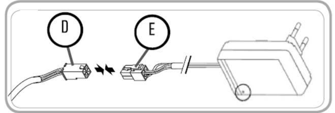
Câbler le connecteur 4 broches du chargeur de batterie externe (E) au connecteur 4 broches du câble Y (D)
