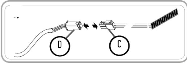
Débrancher le connecteur 2 broches du panneau solaire (C) et le connecteur 4 broches du câble Y (D)
