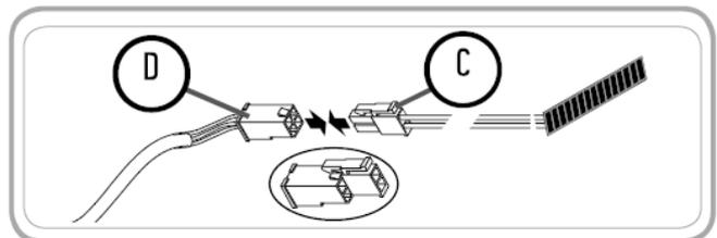
Recâbler le connecteur du panneau solaire (C) au connecteur du câble Y (D)
