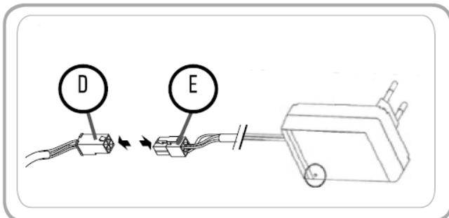
Débrancher le connecteur du chargeur de batterie externe (E) du connecteur du câble Y (D)
